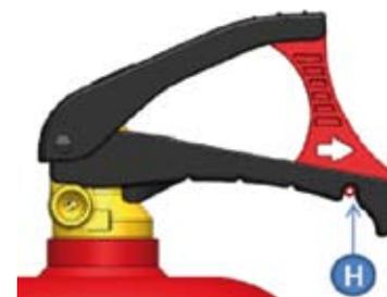
Inserire la spina di sicurezza "E" nella parte terminale delle leve, centrando la stessa prima nel canale centrale della maniglia di trasporto "F", poi nel canale "C" della leva di manovra. Spingere orizzontalmente la spina di sicurezza sino a quando il forellino
